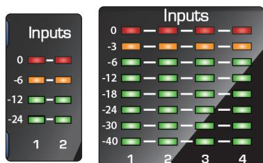
**Eingangspegelanzeigen.** Diese LED-Pegelanzeigen zeigen den Pegel an den analogen Eingängen Ihres Studio-Series Interfaces. Die roten Clip-LEDs leuchten auf, sobald der Pegel am Eingang -0,5 dBFS überschreitet. Ab diesem Pegel kommt es zu einer Übersteuerung der AD-Wandler mit hörbaren Verzerrungen. Verwenden Sie die Gain-Steuerung, um die Pegel unterhalb dieser Grenze zu halten.
