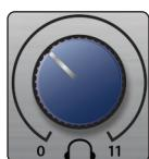
**Kopfhörerlautstärke.** Über diesen Regler steuern Sie den Ausgangspegel für den Kopfhörerausgang auf der Rückseite.
