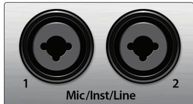
**Instrumenten-Eingänge.** Die 6,35 mm TS-Buchsen für die Kanäle 1 und 2 können mit passiven Instrumenten (Gitarre, Bass etc.) belegt werden. Weitere Informationen finden Sie im Abschnitt *Wahltaste für Eingangssignal..*
