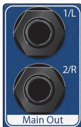
**Main-Ausgänge.** Das sind die Hauptsummenausgänge für Ihr Studio-Series Interface. Der Ausgangspegel für die Main-Ausgänge wird über den Main-Pegelsteller auf der Gerätevorderseite eingestellt. Die Wiedergabe-Streams 1 und 2 werden auf diese Ausgänge geroutet.
