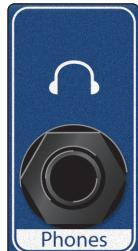
**Kopfhörerausgang.** Der rückseitige Kopfhörerausgang kann zwischen den Wiedergabe-Streams 1/2 und 3/4 umgeschaltet werden. Diese entsprechen den Streams der Ausgänge Main Links/Rechts und Line 3/4. Über die Taste **Cue A/B** schalten Sie zwischen den Streams um.
