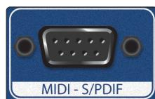
**Anschluss für MIDI-/S/PDIF-Kabelpeitsche (Studio 6|8).** Schließen Sie hier die Kabelpeitsche mit den MIDI- und S/PDIF-Anschläüssen an.
