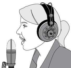
10. Sprechen Sie in das Mikrofon und stellen Sie mit dem MIC-Regler die Mikrofonlautstärke ein. Stellen Sie sich dabei nicht direkt vor den Lautsprecher, um Rückkopplungen zu vermeiden. Wenn Sie den Mikrofoneingang nicht verwenden, belassen Sie diesen Regler in der Minimalposition im Linksschlag, um Störgeräusche im Signalweg auszuschließen.
