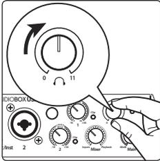
8. Conecta un par de audífonos a la salida de audífonos de la AudioBox USB96 y coloca el control de volumen de audífonos en la posición de las 12:00 en punto.
