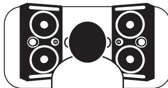
Los altavoces Eris E44 y E66 pueden ser ubicados verticalmente u horizontalmente; Cuando son ubicados horizontalmente, deben formar una imagen espejada del par, con los tweeters hacia afuera.
