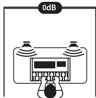
Si los monitores están lejos de las paredes, no realzarán los bajos, entonces coloque el switch en 0 dB.
