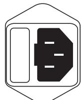
**Conexión de alimentación IEC.** Sus Eris E44/E66 aceptan un cable de alimentación estándar IEC.
