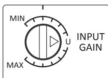
**Control Input Gain.** Ajusta el nivel de la señal de entrada antes de que la misma sea amplificada.
