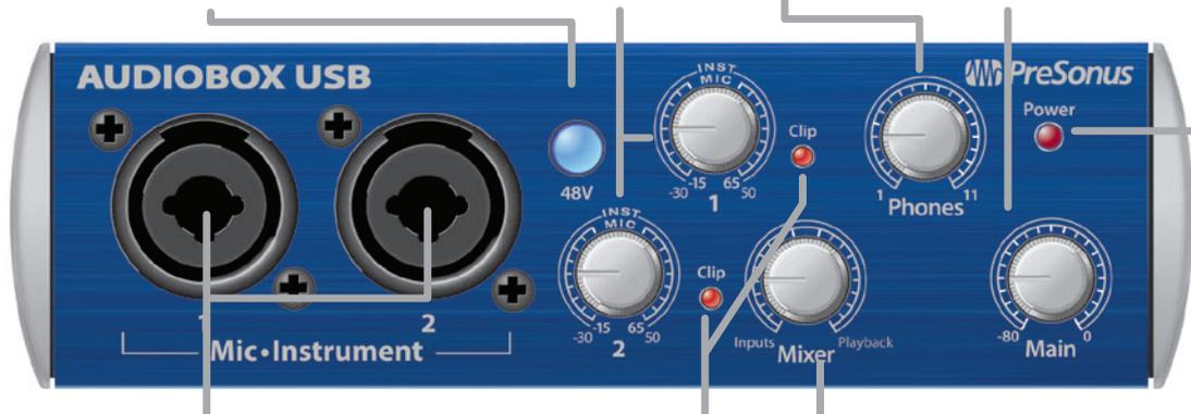
**Mikrofon-/Instrumenteneingänge.** Jeder Eingangskanal bietet je einen Vorverstärker für Mikrofone und Instrumente. Die Combo-Buchsen können wahlweise mit 6,35 mm Klinken- (TS) oder XLR-Kabeln belegt werden. Verwenden Sie 6,35 mm Klinkenkabel für Gitarren und andere passive Instrumente. Verwenden Sie XLR-Kabel für Ihr M7-Mikrofon.
