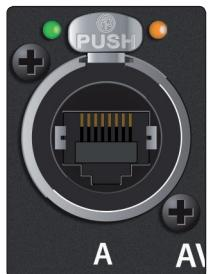
**AVB A.** Esta conexión Ethernet con bloqueo debería usarse para conectar su NSB a su red AVB.
