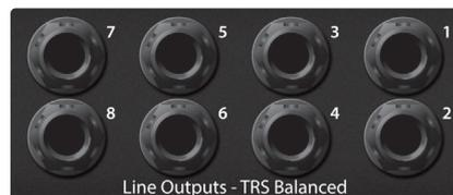
**Sorties ligne.** L'interface Quantum 2626 a 8 sorties ligne symétriques sur jacks TRS pour envoyer des signaux à des appareils externes tels que des amplis pour casques, des processeurs de signal et des moniteurs supplémentaires. Chaque sortie produit son propre flux de lecture. Chaque sortie ligne est couplée en CC pour fournir une tension de commande à des équipements analogiques externes. Cette fonction peut être utilisée avec n'importe quel plug-in qui la prend en charge.
