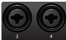
**Entrées microphone/ligne.** Les connecteurs jack 6,35 mm 3 points (TRS) des canaux 3 à 8 servent à l'emploi avec des sources de niveau ligne (synthés, claviers, processeurs d'effets, etc.). Quand un appareil est branché à l'entrée ligne, le préampli micro est court-circuité et le signal est envoyé à l'étage de préamplification d'instrument.
