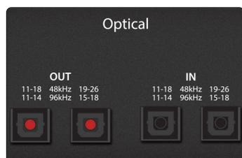
**ADAT – Entrées et sorties multiplexées (S/MUX).** Ce sont des connexions ADAT – Dual S/MUX (multiplexées) pour vos appareils numériques externes. Lors de l'enregistrement ou de la lecture à 44,1 ou 48 kHz, chaque entrée/sortie ADAT fournit 8 des 16 canaux disponibles dans l'ordre, de gauche à droite. Lors de l'enregistrement ou de la lecture en 88,2 ou 96 kHz, chaque connexion fournit 4 des 8 canaux disponibles.
