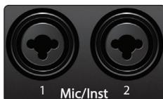
**Entrées microphone/instrument.** Les connecteurs jack 6,35 mm 2 points (TS) des canaux 1 et 2 servent à l'emploi avec un instrument (guitare, basse, etc.). Quand un instrument est branché à l'entrée instrument, le préampli micro est court-circuité et le signal est envoyé à l'étage de préamplification d'instrument.
