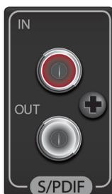
**S/PDIF IN y OUT.** Las conexiones S/PDIF permiten transmitir y recibir dos canales de audio a tasas de hasta 24 bits, 96 kHz. La E/S S/PDIF también permite a las interfaces de la serie Studio 192 enviar y recibir word clock desde y hacia dispositivos externos digitales.
