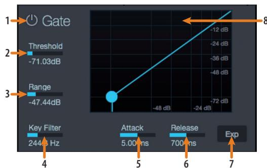
1. **Botón Encendido/Apagado de Compuerta.** Habilita/Deshabilita la compuerta para el canal de entrada analógico seleccionado.
