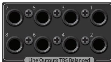
**Salidas de línea 1-8/4.** Las interfaces de la serie Studio 192 poseen ocho/cuatro salidas de línea balanceadas para enrutar a dispositivos externos, tales como amplificadores de auriculares, procesadores de señales y monitores adicionales. Cada salida posee un stream de reproducción independiente (streams de reproducción 3-10/6).
