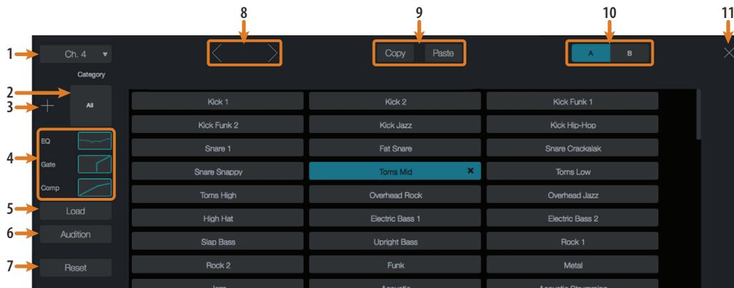
1. **Selección de canal.** Muestra el canal actualmente seleccionado. El gestor de presets automáticamente cargará y almacenará los presets para y desde este canal. Haga clic en este menú para seleccionar un nuevo canal para gestionar.
