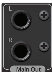
**Salidas principales Main Out.** Estas son las salidas principales para las interfaces de la serie Studio 192. El nivel de salida para las salidas principales es controlado por la perilla Main localizada en el panel frontal de la unidad. Al igual que las salidas de línea, las salidas principales poseen streams de reproducción independientes (streams de reproducción 1-2).
