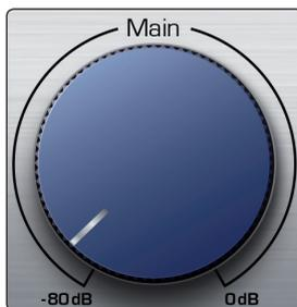
**Control Main.** La perilla Main controla el nivel de salida para las salidas principales localizadas en el panel posterior de las interfaces de la serie Studio 192 y posee un rango de -80 dB a 0 dB. Este control proporciona solamente atenuación.
