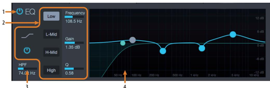
1. **Encendido/Apagado del Ecuador.** Habilita/Deshabilita el EQ para el canal analógico de entrada seleccionado.
