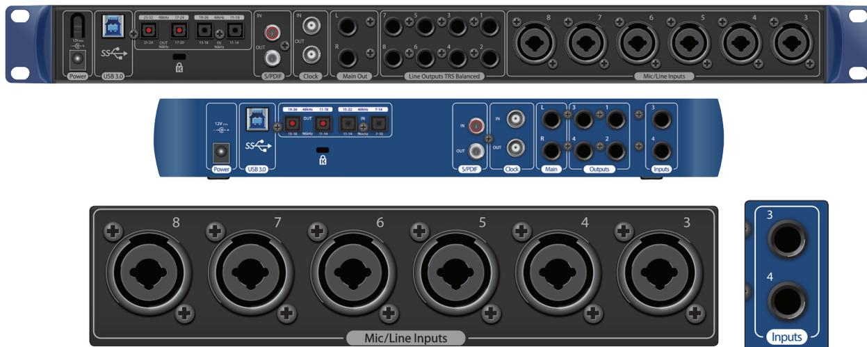
**Entradas de línea 3-8/4.** Los conectores TRS de 1/4 de pulgada en los canales 3-8/4 son para utilizar con dispositivos con salida de línea. Estas entradas están escaladas para aceptar señales con niveles de línea hasta +18 dBFS.
