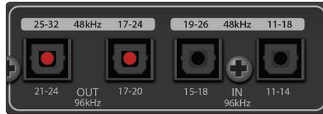
**ADAT – S/MUX IN y OUT.** Estas son las conexiones ADAT – Dual S/MUX para sus dispositivos digitales externos. Cuando graba o reproduce a 44.1 o 48 kHz, cada E/S ADAT proporcionará 8 de los 16 canales disponibles consecutivamente, de izquierda a derecha. Cuando graba o reproduce a 88.2 o 96 kHz, cada conexión proporcionará cuatro de los ocho canales disponibles.
