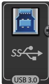
**Puerto USB 3.0.** Use este puerto para conectar su interfaz de la serie Studio 192 a su computadora. Dado que las interfaces de la serie Studio 192 son verdaderos dispositivos USB 3.0, son completamente compatibles con conexiones USB 2.0. No conecte su interfaz de la serie Studio 192 a una conexión USB 1.1 o inferior en su computadora.
