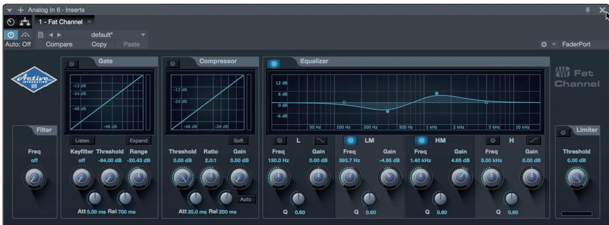
Haga clic en el botón Aplicar DSP a la señal de entrada en la esquina superior izquierda del plugin Fat Channel para grabar la configuración Fat Channel con su audio.
