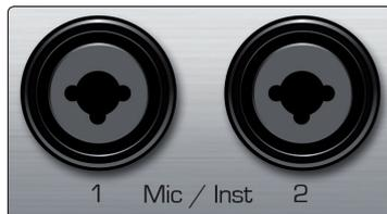
**Entradas de micrófono** Su interfaz de la serie Studio 192 está equipada con ocho/dos preamplificadores de micrófono PreSonus XMAX controlables remotamente para usar con todo tipo de micrófonos. El diseño XMAX proporciona un buffer de entrada Clase A, seguido por una etapa de ganancia dual-servo. Esta disposición lo hace un preamplificador de ultra bajo ruido con un amplio control de ganancia, permitiendo aumentar el nivel de señales de entrada sin incrementar el ruido de fondo no deseado.
