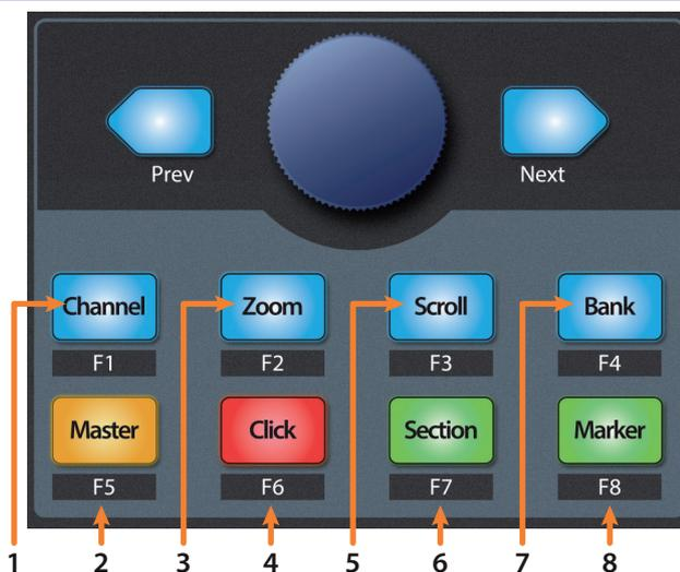
1. **Channel.** El encoder controla el desplazamiento en cada canal individual. Los botones de navegación ajustan el banco de fader visible en ese momento en el FaderPort por un banco de ocho o dieciseis canales (dependiendo del modelo).
