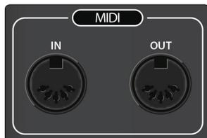
**MIDI-I/O (AudioBox iTwo).** MIDI steht für „Musical Instrument Digital Interface“. Über die MIDI-Ein- und -Ausgänge ist der Anschluss und die Kommunikation mit externen MIDI-Geräten möglich. Eine Funktion dieser Ports ist das MIDI-Sequencing – allerdings können Sie das MIDI-Protokoll für weit mehr als für Instrumente und das Sequencing nutzen.
