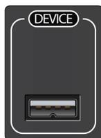
**Device-Port.** Hier können Sie ein Apple-kompatibles 30-Pol- oder Lightning-auf-USB-Kabel anschließen, um Ihre AudioBox mit einem iPad zu verbinden und für die Wiedergabe und Aufnahme mit Audio-Anwendungen zu nutzen. (Wir empfehlen, das mit dem iPad ausgelieferte Kabel zu verwenden, da es in Verbindung mit Apple-fremden Kabeln zu Problemen kommen kann.) Die minimalen Systemanforderungen sind später im Abschnitt iOS-Geräte angegeben.
