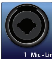
**Mikrofon-/Instrument-/Line-Eingänge.** Beide Kanäle der AudioBox iTwo verfügen über Mic-Line/Instrument-Combo-Buchsen zum Anschluss von 6,35 mm TRS- oder XLR-Steckern.
