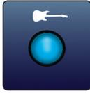
**Taste Input Source (AudioBox iTwo).** Für jeden Eingangskanal der AudioBox iTwo steht eine Taste zur Auswahl der Eingangsquelle zur Verfügung, mit der Sie die 6,35 mm Buchsen zwischen Instrumenten- und Linepegel umschalten können. Wenn die Taste nicht leuchtet, ist der Eingang für Line-Quellen wie Synthesizer oder Gitarren-Amp-Modeller ausgelegt. Drücken Sie die Taste hingegen, wenn Sie den Instrumenten-Preamp zum Anschluss von Gitarren oder passiven Bassgitarren aktivieren möchten.
