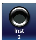
**Instrumenten-Eingänge.** Diese 6,35 mm Buchsen sind für Instrumente ohne internen Preamp (Gitarre, Bass u. ä.) vorgesehen. Weitere Informationen finden Sie im Abschnitt zur Taste Input Source.
