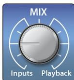
**Mix-Regler für das Direct-Monitoring (AudioBox iTwo).** Mit Hilfe des Mix-Reglers können Sie die Eingangssignale mit dem Wiedergabe-Stream Ihres Computers mischen. Auf diese Weise können Sie die Eingänge latenzfrei abhören. In der 12-Uhr-Reglerstellung werden der Eingang und das Playback-Signal zu gleichen Teilen übertragen.
