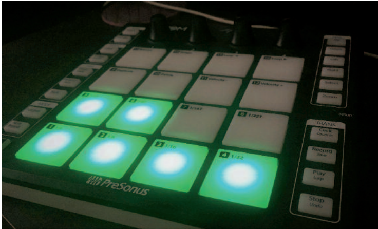
Vor dem Einsatz müssen zunächst Universal Control und ein Firmware-Update aufgespielt werden – der Controller zeigt den Installationsfortschritt durch die leuchtenden Pads an
